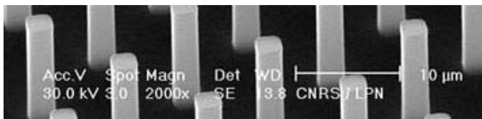
Matériau texturé par un motif en plots (ou en piliers), vu au microscope électronique. La barre indique 10
