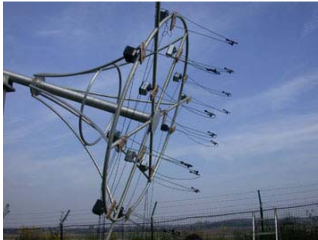
« Parapluie anti-bruit actif » prototype installé en bordure d'aéroport. © LMA.
