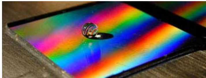
Goutte d'eau millimétrique sur un substrat texturé hydrophobe : la goutte garde la forme d'une perle (on dit du matériau qu'il est super-hydrophobe). La texture est un réseau de plots régulièrement organisés à l'échelle du micron, ce qui confère au matériau ses couleurs. © Mathilde Callies, David Quéré.
