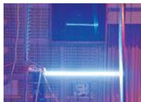
Décharge de haute tension avec guidage laser
