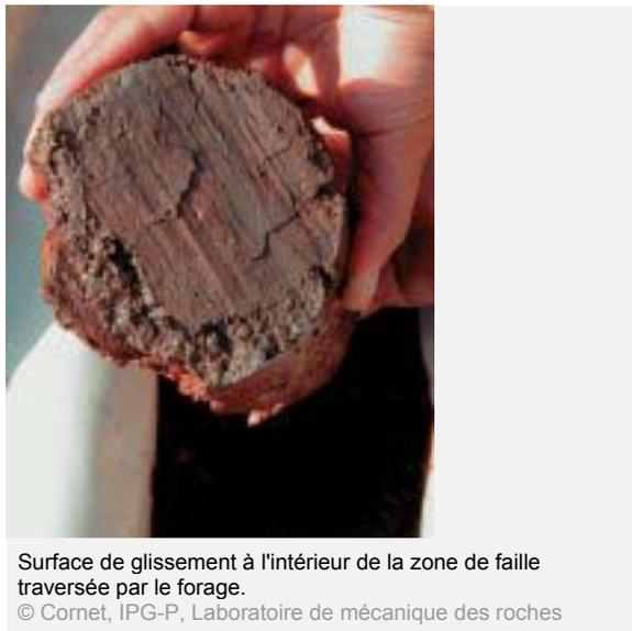
Surface de glissement à l'intérieur de la zone de faille traversée par le forage.
