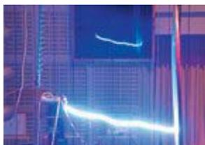
Décharge de haute tension sans guidage laser
