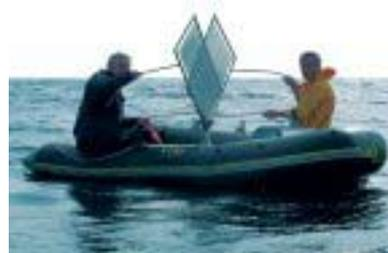
Prélèvement de la microcouche de surface à l'aide de tamis métalliques. L'eau est ensuite collectée dans des bouteilles en verre très propres.
