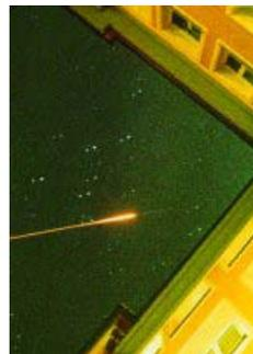
Image d'un filament auto-guidé induit dans l'air par des impulsions laser infrarouge (800 nm) de forte puissance crête.
