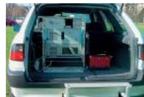
Le véhicule STRADA du laboratoire HEUDIASYC (le capteur à l'arrière est un télémètre laser et l'antenne sur le toit un récepteur GPS différentiel).
