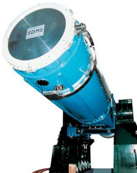
THÉMIS est un magnétographe destiné à la mesure du champ magnétique dans les structures fines de l'atmosphère du Soleil. Il est équipé d'un télescope sous vide de 90 cm d'ouverture associé à deux spectrographes.
