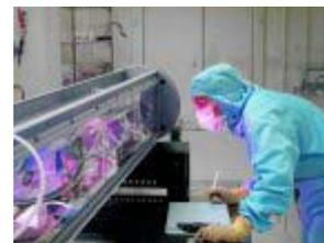
Assemblage en salle blanche d'un amplificateur à disques du laser *Luli2000*.
