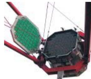
La caméra de 1,5 mètre de diamètre, construite par les équipes françaises et placée au foyer du télescope, permet de numériser les signaux lumineux avec une résolution temporelle d'une nanoseconde.
