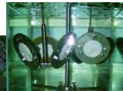
Les échantillonneurs passifs de type POCIS (Polar Organic Chemical Integrative Sampler), ici en cours d'étalonnage, permettent de collecter les composés organiques présents dans l'eau.
