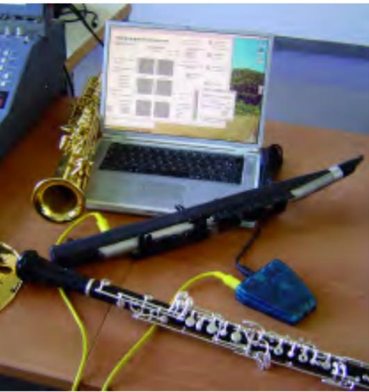
Au centre, un instrument à vent numérique utilisé au cours du programme Consonnes. Il est constitué d'un capteur de gestes qui pilote un logiciel de synthèse sonore reposant sur le fonctionnement des instruments réels.
