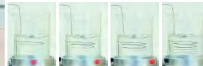
L'injection de nanotubes de carbone en solution dans un bain spécial, dit de coagulation, tournant sur lui-même permet de former des fibres de nanotubes.
