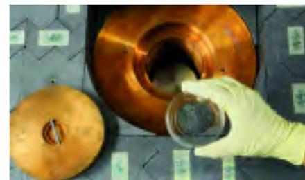
Les échantillons à analyser sont disposés sur les détecteurs au germanium dans des cuves blindées au cuivre et au plomb.
