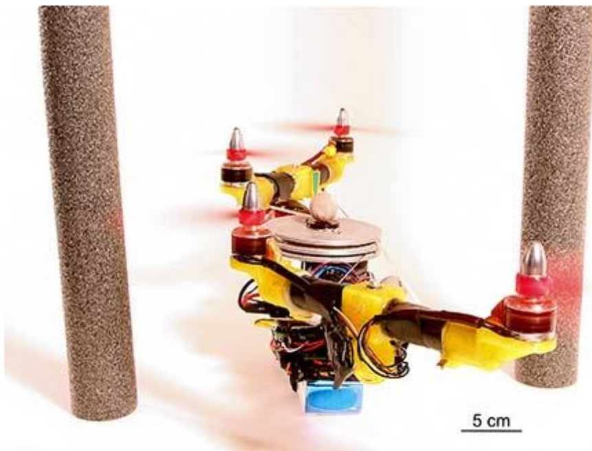
The Quad-Morphing robot. © Valentin Rivière and Stéphane Violette, Étienne Jules Marey Institute of Movement Sciences (CNRS / Aix-Marseille Université)
