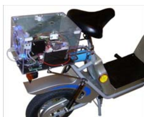
scooter hybride batteries/pile à combustible H 2 /O 2
