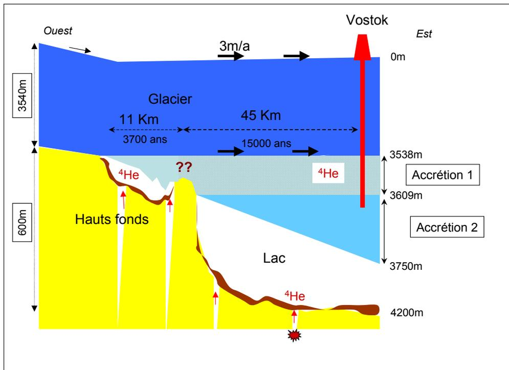
**Schéma en coupe du glacier s'écoulant vers Vostok et du lac sous glaciaire.** Le glacier s'écoule de gauche à droite à la vitesse de 3m par an environ, et l'eau du lac qui gèle s'accumule progressivement sous le glacier et s'épaissit à la vitesse de l'ordre de 1 cm par an. A Vostok l'épaisseur de glace d'accrétion est de 220 m.
