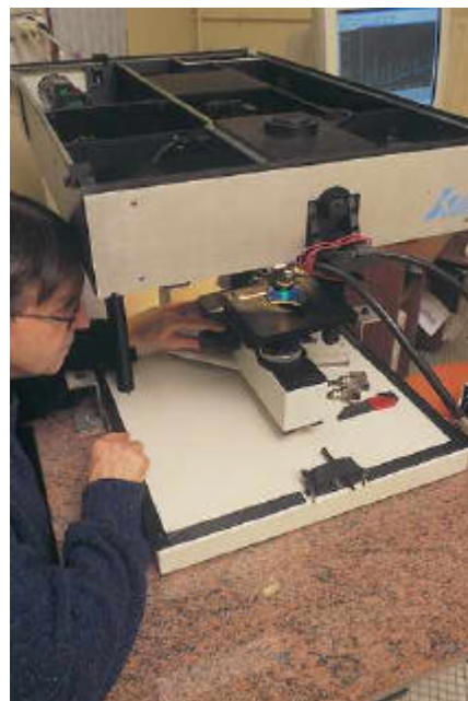
© L. Médard, CNRS photothèque Analyse d'une céramique ancienne au microscope Raman portable. La recherche a pour objectif d'identifier des pigments et de comprendre des techniques anciennes d'élaboration.
