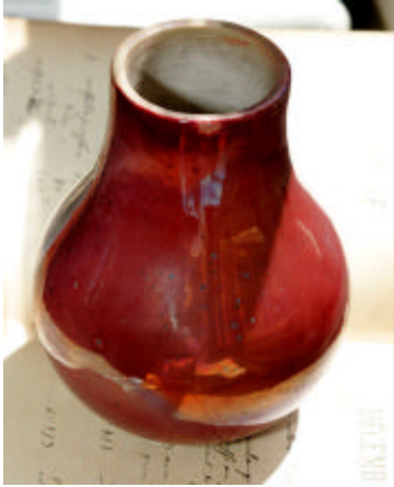
© Ph. Colomban / Manufacture nationale de Sèvres Vase d'essai de porcelaine à lustre rouge et or côté face, argent de l'autre, avec sa recette. La date inscrite dessous a permis de retrouver la composition utilisée pour l'émail. Les vases d'essai sont utilisés pour mettre au point les couleurs des émaux, sur des pièces entières.
