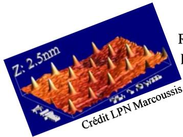
Réseau de défauts créés par faisceau d'ions focalisés sur surface de graphite
