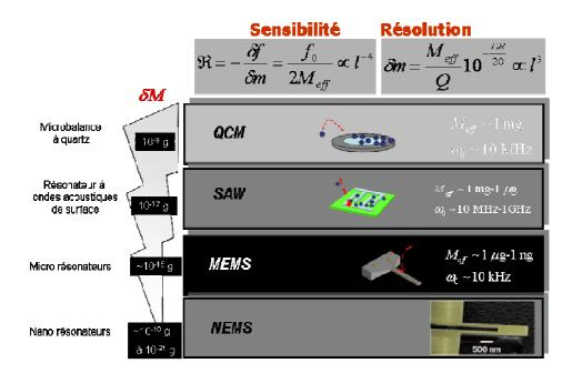
Evolution de la résolution de balances électro-mecaniques du macro au nano (QCM : quartz crystal microbalance pour microbalance à quartz, SAW : surface acoustic wave pour onde acoustique de surface)
