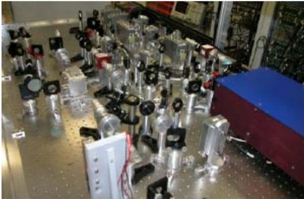
Sur cette table, appelée « banc lasers », se trouvent des lasers de puissance de 20 Watts avec leurs stabilisations. © CNRS Photothèque/EGO-VIRGO / BARILLE R.
