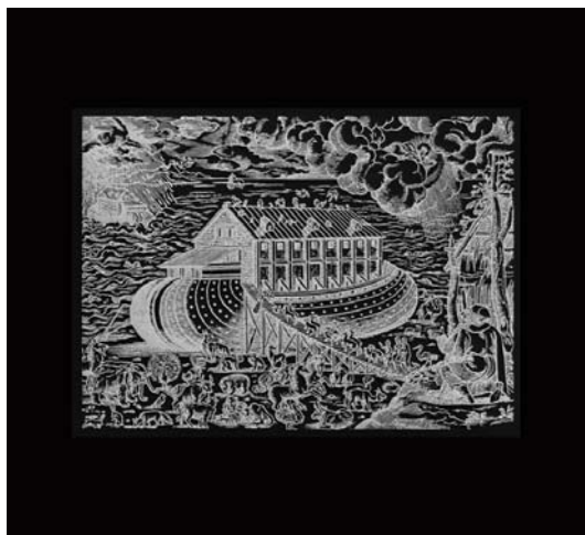
L'Arche de Noé, d'après une illustration d'une Bible de Luther datant de 1564. Nano-fabrication par lithographie électronique. 227\ \mu\text{m} \times 164\ \mu\text{m} . Vue au microscope électronique à balayage. Or sur silicium.
