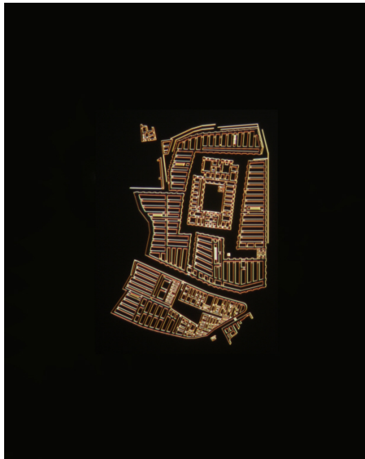
Hattusha, Grand Temple. Nano-fabrication par lithographie électronique 187\ \mu\text{m} \times 261\ \mu\text{m} . Vue au microscope optique. Or sur silicium.
