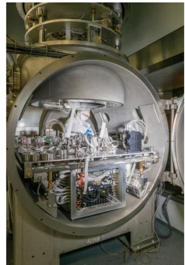
*Insertion d'un banc optique dans son enceinte à vide © CNRS/Cyril Fréssillon*
