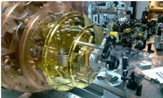
*Système de refroidissement par dilution utilisé pour diminuer le bruit thermique mécanique d'un système. © CNRS/A. Kuhn*
