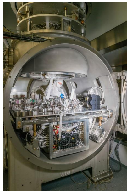
Insertion d'un banc optique dans son enceinte à vide (2016) © CNRS/Cyril Fréssillon
