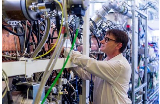
Cavité en cuivre pur RFQ (Radio Frequency Quadrupôle) dans le grand hall du Linac (LINear ACcelerator) de Spiral2. © Philippe Stroppa/CEA/CNRS
