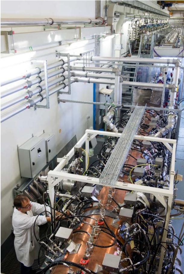
Cavité en cuivre pur RFQ (Radio Frequency Quadrupôle) dans le grand hall du Linac (LINear ACcelerator) de Spiral2. © Philippe Stroppa/CEA/CNRS
