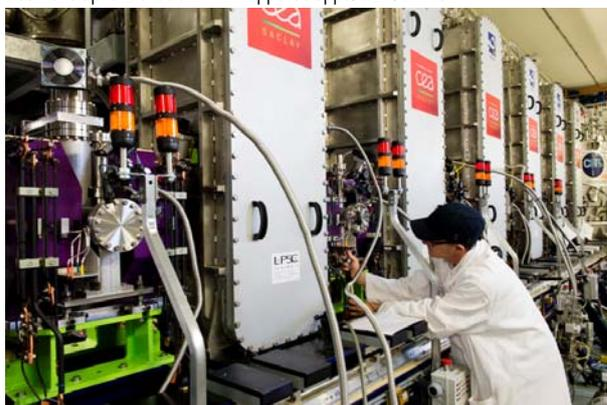
Cryomodules supraconducteurs renfermant les cavités accélératrices du Linac (LINear ACcelerator) de Spiral2. © Philippe Stroppa/CEA/CNRS
