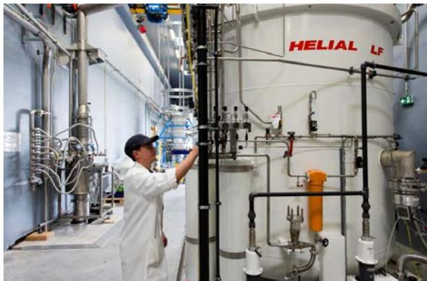
Usine cryogénique produisant de l'hélium liquide pour alimenter le Linac (LINear ACcelerator) de Spiral2. © Philippe Stroppa/CEA/CNRS
