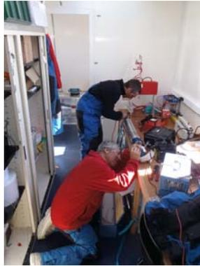
DC\_VK\_GT\_08: Préparation et réglage dans le laboratoire chaud de la sonde POSSUM : mesure de la surface spécifique (taille) des grains de neige dans un trou de forage.
