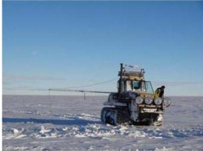
*Le radar neige : Manu LeMeur et le Challenger n°5 équipé du radar neige, trainé au sol au bout d'une longue perche. Sur le véhicule une antenne GPS permet le positionnement des mesures. Photo prise le 14 janvier à 23h30, juste après le retour du "raid éclair" depuis Concordia. (Photo J. Chappellaz/LGGE)*
