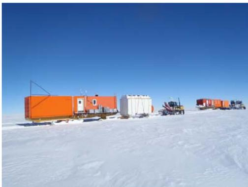
DC\_VK\_GT\_09: Une partie du convoi avec à gauche la caravane vie, le container blanc pour le stockage des échantillons et la caravane énergie sur la droite.
