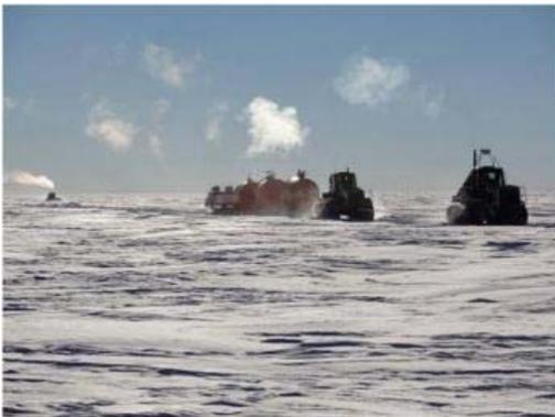
*Arrivée d'une partie du raid à S1bis le 11 janvier. Le premier tracteur, arrivé le premier à S1bis, est reparti pour aider le deuxième tracteur qui tirait une lourde charge et allait moins vite. On voit l'élingue liant les deux tracteurs. Derrière, on distingue le Kassbohrer Pisten Bully qui nivelle la trace en vue de passages ultérieurs dans les années à venir. Photo J.Chappellaz/LGGE.*
