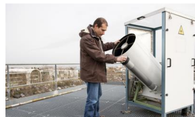
Lidar installé sur le toit de l'OPGC
