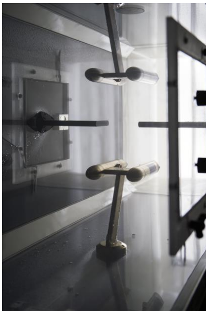
Intérieur de la soufflerie Test d'instruments de caractérisation des nuages
