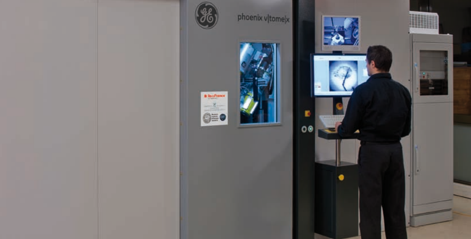
Le microtomographe v|tome|x L240 de la plate-forme AST-RX (© P. Lafaité / MNHN)
