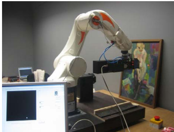
Microscope confocal permettant l'étude de l'état de surface d'une œuvre d'art.
