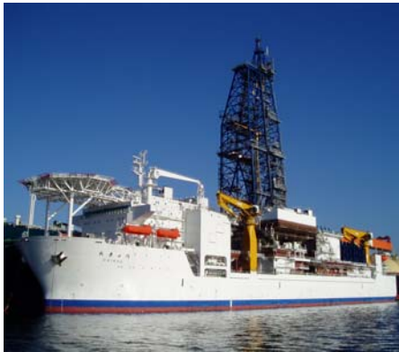
Le Chikyu est un navire à la pointe de la technologie spécialement construit et mis en œuvre par les Japonais pour le programme IODP. Il va permettre de forer jusqu'à 7 km de profondeur sous le fond de l'océan.
