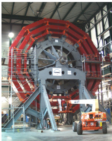
Assemblage du détecteur CMS qui doit observer les collisions proton-proton au LHC.
