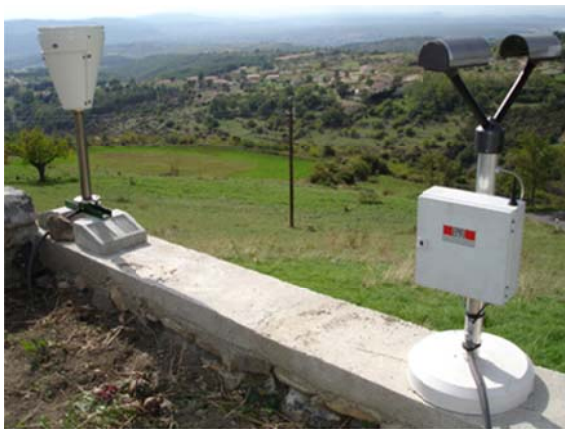
Pluviomètre précis mécanique (à gauche) du Laboratoire d'Etude des Transferts en Hydrologie et Environnement et spectropluviomètre optique OTT Parsivel (à droite) de l'Ecole Polytechnique Fédérale de Lausanne en Suisse, installés en Ardèche. Le spectropluviomètre mesure la taille et la vitesse des hydrométéores (gouttes de pluie ou particule de glace) à l'aide d'un petit faisceau laser dont le signal est atténué lorsqu'il est intercepté par ces hydrométéores. Le pluviomètre mesure de manière directe l'intensité de la pluie à l'aide d'un cône et d'un système d'augets : le volume de l'auget est connu et chaque basculement est horodaté. © Brice Boudevillain (LTHE) et Alexis Berne (EPFL).
