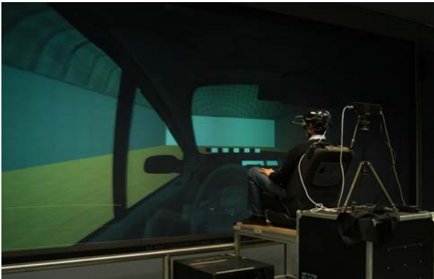
Montage expérimental pour l'étude de la perception des distances proches en environnement virtuel
