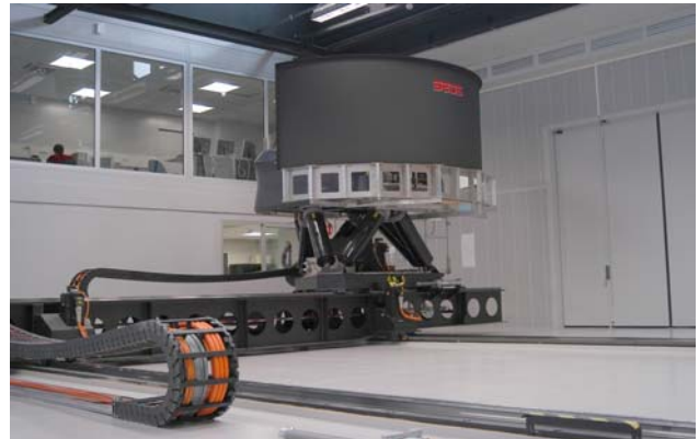
ULTIMATE, simulateur de conduite à haute performance développé par Renault pour l'étude de la perception du mouvement
