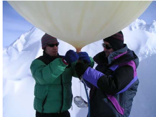
Réf : 2007N00140 Chercheurs préparant un lancement de ballon météo à Concordia. Une sonde météo Vaissala y est accrochée, mesurant température, pression, humidité et vecteur vitesse du vent en fonction de l'altitude. © CNRS Photothèque / ARISTIDI, Eric
