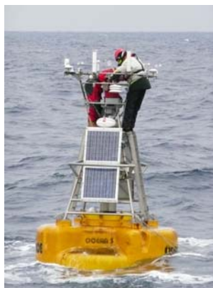
Bouée instrumentée Météo-France dans le Golfe du Lion, maintenance des capteurs HyMeX. © S.Belamari.
