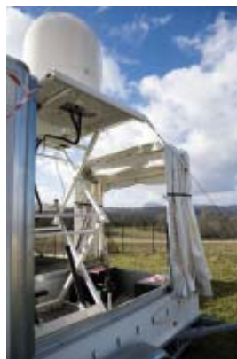
Radar bande X mobile du Laboratoire de Météorologie Physique (LaMP), à haute résolution spatiale et temporelle (90 m et 3 minutes) et d'une portée typique de 20 km. © LAMP/CNRS Photothèque / FRESILLON Cyril.
