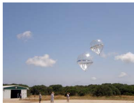
Lancement de ballons pressurisés couche limite, pour la mesure de l'ozone et des aérosols, campagne ChArMEx 2013, Minorque, juin 2013. © François Dulac.
