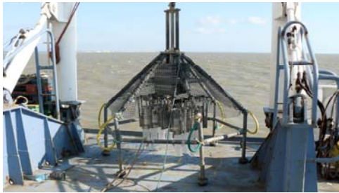
Carottier multitubes prêt à être mis à l'eau pour un prélèvement de sédiment en face de l'embouchure de l'Aude en crue © X. Durrieu de Madron MERMeX
