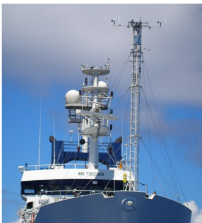
Figure 1 : Vue du mât instrumenté monté à l'avant du navire Suroît pendant la campagne CIRENE
