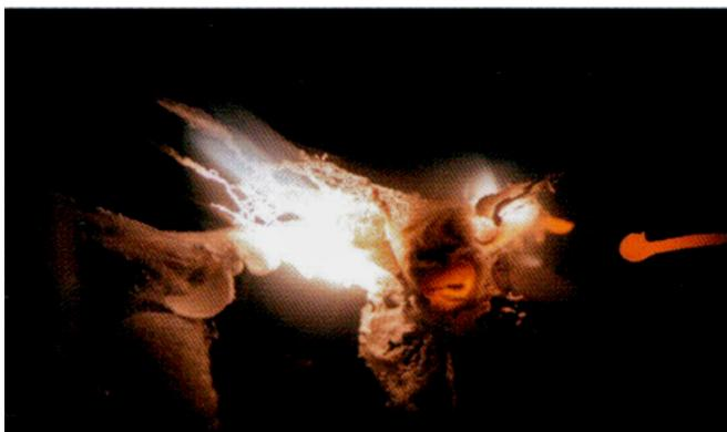
Combustion d'une particule de magnésium de diamètre 50 microns dans du CO<sub>2</sub> et en microgravité
