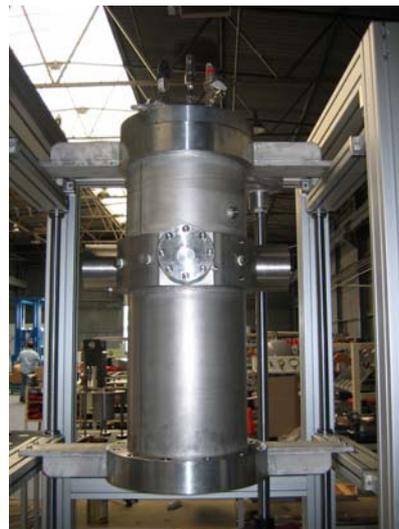
À gauche, vue d'ensemble des brûleurs « jumeaux » à contre-courants montés en vis-à-vis. Ceux-ci sont placés dans une enceinte haute pression, photo de droite, (1-50 bars) et permettent l'étude de deux flammes laminaires de prémélange, identiques ; © ICARE-CNRS/Christian Vovelle.
