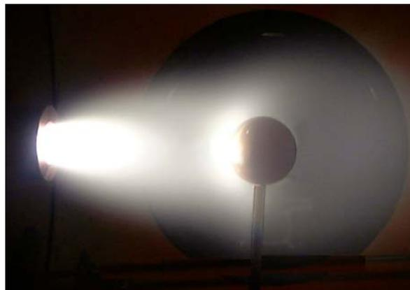
À gauche, vue d'artiste de l'orbiteur *Mars Explorer* ; à droite, Interaction entre un jet supersonique de plasma obtenu à partir d'un mélange CO<sub>2</sub>-N<sub>2</sub> et une sphère métallique ; © ICARE-CNRS.
