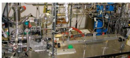
À gauche, vue d'ensemble de la chambre de simulation atmosphérique (d'un volume de 8 m<sup>3</sup>) ; à droite, réacteur à écoulement et spectromètre de masse ; © ICARE-CNRS.
