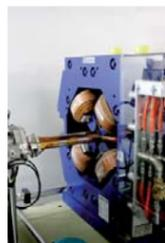
Les 160 quadrupôles assurent la focalisation du faisceau d'électrons.
