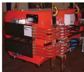
Les 32 dipôles ou aimants de courbure de SOLEIL guident la trajectoire des électrons en les faisant tourner et produisent la lumière synchrotron.
