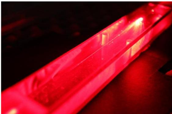
Faisceau laser rouge (hélium-néon) passant dans une microfibre optique.
