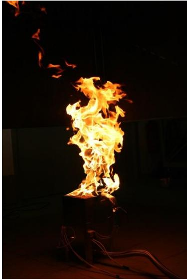
Expérience de mesure de la puissance d'un brûleur propane.
