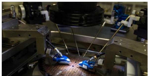
Caractérisation électrique haute fréquence d'interconnexions dans un empilement 3D de circuits intégrés
