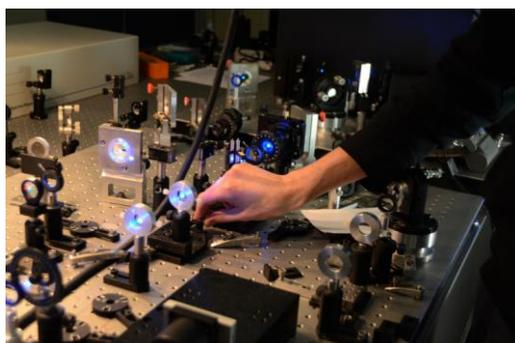
A gauche : Alignement des faisceaux optiques d'une expérience de spectroscopie optique pompe-sonde ultrarapide, sur une nanoparticule individuelle. Cette expérience utilise une technique de spectroscopie par modulation spatiale.
