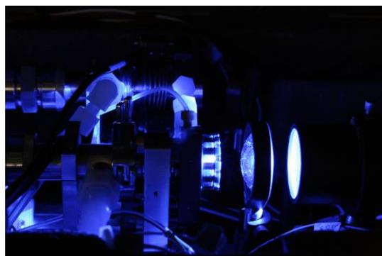
Spectromètre d'absorption optique différentielle (DOAS). Issu de l'université de Boulder (USA), cet instrument est actuellement à l'Ircelyon.
