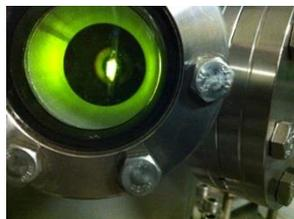
Lumière verte provenant d'un cristal de YAG:Ce excité par des électrons.
