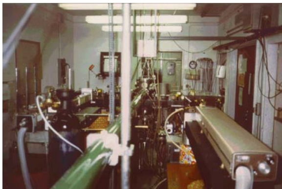
L'expérience de test des inégalités de Bell d'Orsay (1982). La source de paires de photons intriqués comportait plusieurs lasers, et un jet atomique se propageant dans une enceinte atomique que l'on distingue au centre. Les mesures se faisaient après 6 mètres de propagation de part et d'autre de cette source. © Groupe d'optique atomique /LCFIO
