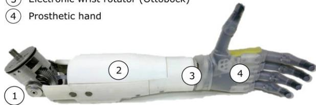
Prototype de prothèse de bras utilisé pour les essais, composé d'un coude motorisé (1), d'un rotateur motorisé de poignet (3) et d'une main polydigitale Robolimb de Touch Bionics (4).
