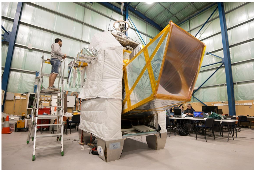
L'instrument scientifique PILOT en fin d'intégration dans le hall de la NASA à Alice Springs (Australie). Le baffle avant permet d'atténuer les lumières parasites dues à l'émission thermique de la Terre et de l'enveloppe du ballon stratosphérique.
