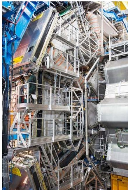
Figure 3: ©Cyril FRESILLON/LHC/CNRS Photothèque - Atlas, le détecteur de particules le plus volumineux jamais construit pour la physique des particules (46m de long pour 25m de haut), en position ouverte pendant une période d'arrêt. Conçu pour comprendre notre Univers et son évolution, il détecte les particules élémentaires produites lors des collisions protons-protons.
