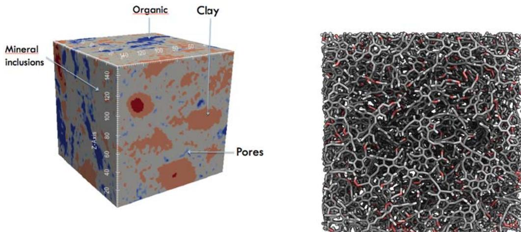
Image par microscopie de rayons X (XRM) d'un échantillon non traité de schiste gazeux, montrant des inclusions de pyrite, d'argile, de matière organique et d'autres minéraux.
