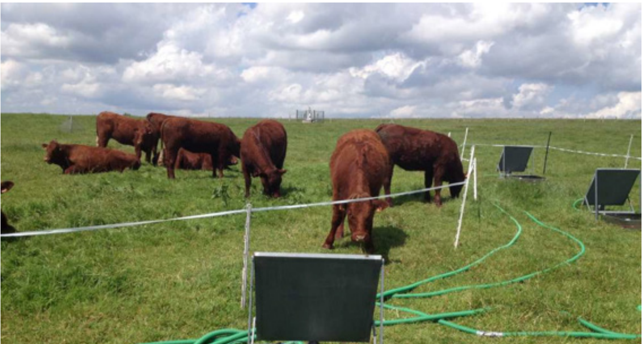
Mesure des émissions de protoxyde d'azote ( N_2O ), en écosystème prairial, Station de Laqueuille, Clermont-Ferrand (© INRA)
