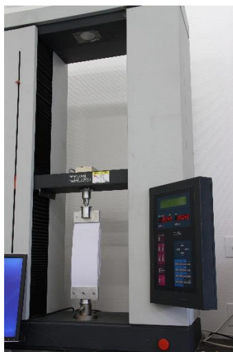
Dispositif expérimental utilisé au laboratoire pour mesurer la force de friction. © Frédéric Restagno et Christophe Poulard.
