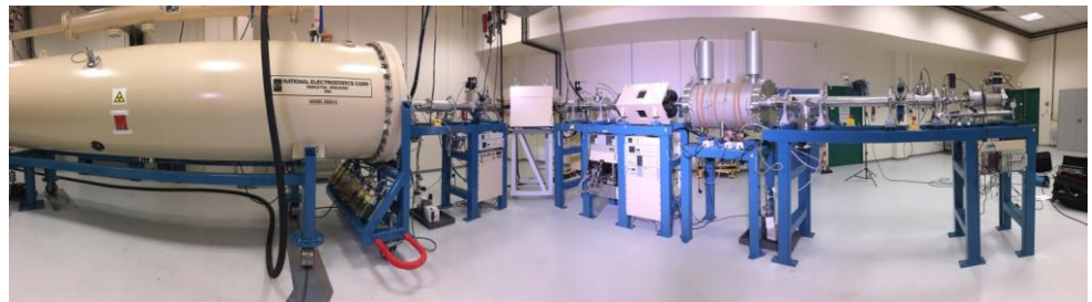
Spectrométrie de masse par accélérateur du LMC14 utilisé pour dater les cosmétiques (c) CEA/L. Godart
