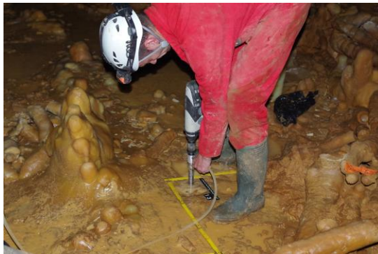
Carottage dans le plancher stalagmitique à l'intérieur de l'une des structures de la grotte de Bruniquel © Michel SOULIER – SSAC.
