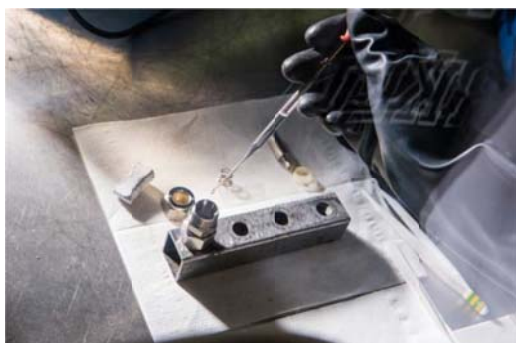
Assemblage de cellule pour le test de matériaux de batteries sodium-ion (Na-ion), dans une boîte à gants. Ces matériaux sont testés face à des électrodes de référence en sodium.
