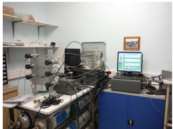
Dispositif expérimental de mesure des concentrations de gaz à effet de serre. © O. Llado
