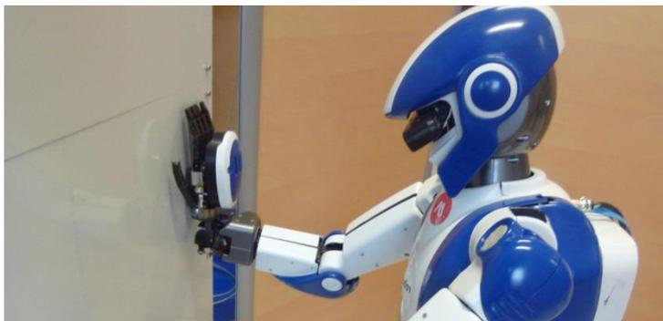
*Un robot humanoïde vérifiant la fonctionnalité d'un panneau de commande.
