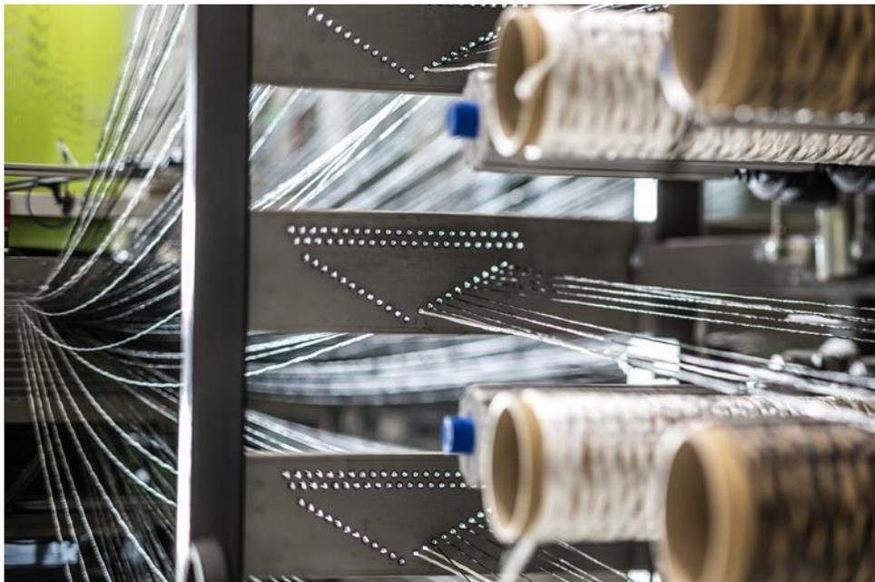
*Métier à tisser la fibre de carbone utilisée pour la fabrication du moteur LEAP.
