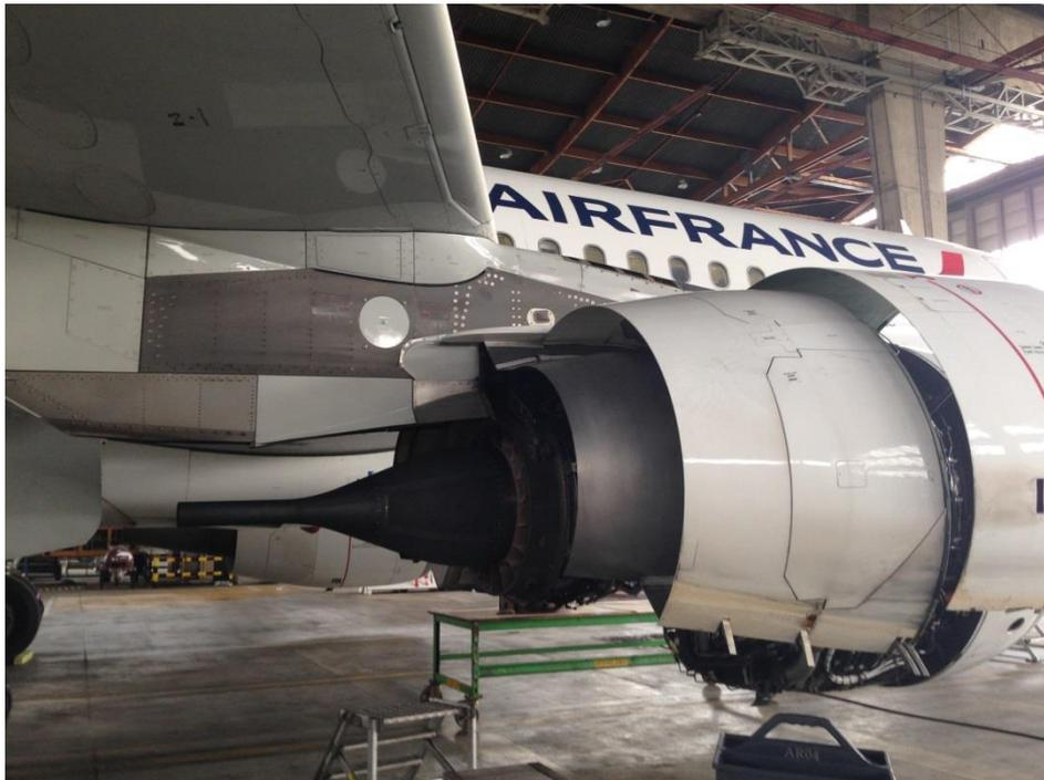
Cône d'éjection en composite à matrice céramique.
