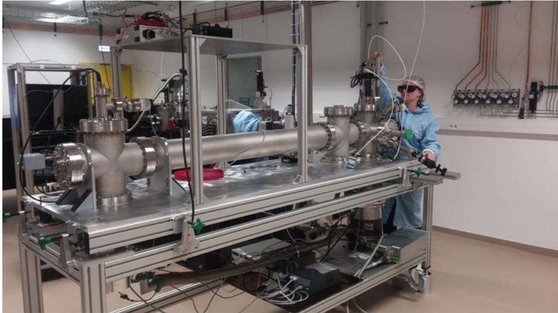
Dispositif expérimental : on distingue, devant l'expérimentatrice, l'enceinte où les atomes d'hélium sont photoionisés. Les électrons éjectés sont guidés par un champ magnétique vers un détecteur situé dans la cellule de gauche. Entre les deux, le long temps de vol de 2 mètres de long permet d'analyser en énergie les électrons émis avec une résolution de  $\sim 0.2$  électron-volt. Crédit photo : M. Turconi – CEA.
