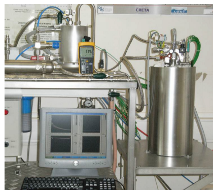
Photo du réservoir qui stocke 110g H_2
