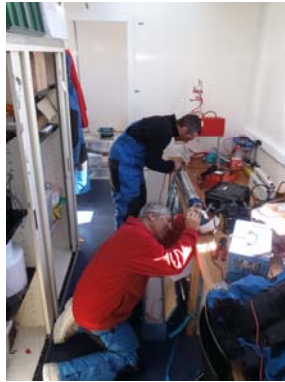
DC_VK_GT_08: Préparation et réglage dans le laboratoire chaud de la sonde POSSUM : mesure de la surface spécifique (taille) des grains de neige dans un trou de forage. © Gregory Teste / LGGE
