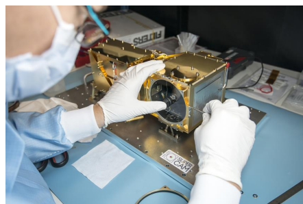
Intégration finale du modèle de SuperCam qui servira pour des tests mécaniques et thermiques.
