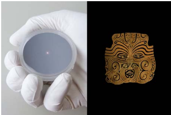
Plaque de silicium avec nanofabrication : tatouage maori. Nano-fabrication par lithographie électronique. 359\ \mu\text{m} \times 368\ \mu\text{m} . Vue au microscope optique. Or sur silicium.
