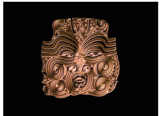
Tatouage maori, Nouvelle-Zélande, vers 1800. Nano-fabrication par lithographie électronique. 359\ \mu\text{m} \times 368\ \mu\text{m} . Vue au microscope optique. Or sur silicium.
