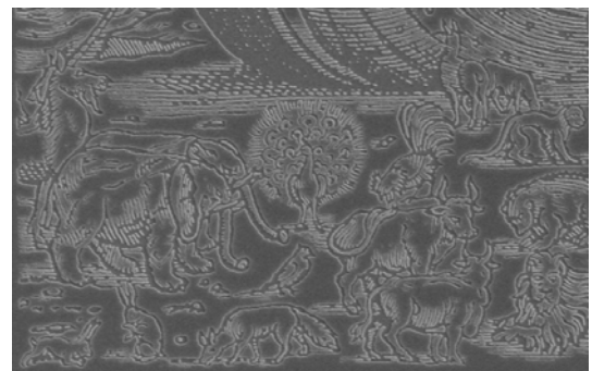
L'Arche de Noé (détail), d'après une illustration d'une Bible de Luther datant de 1564. Nano-fabrication par lithographie électronique. 227\ \mu\text{m} \times 164\ \mu\text{m} . Vue au microscope électronique à balayage. Gravure sur silicium.
