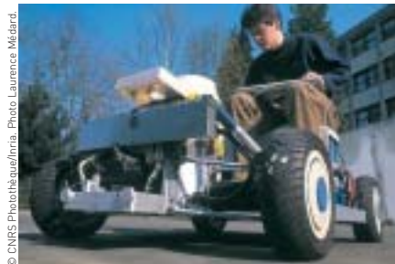
Prototype de véhicule entièrement piloté par informatique, avec électronique embarquée, le Cycab.
