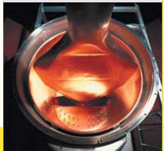
Mise en place du résonateur du cyclotron de moyenne énergie de l'ensemble Spiral pour l'accélération des noyaux exotiques.
