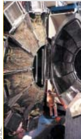
Chambre DIRC du détecteur Babar pour l'étude de la violation de symétrie CP au Stanford Linear Accelerator.
