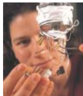
Les nanotechnologies sont au cœur des priorités scientifiques du CNRS. Ce cryostat à dilution permet de mesurer la résistance électrique de nanotubes de carbone et d'explorer leurs propriétés supraconductrices.
