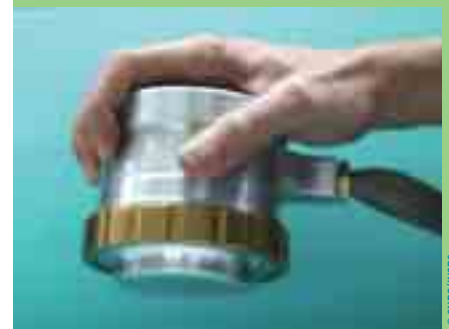
La gamma caméra miniaturisée POCI permet la localisation de lésions tumorales radio-marquées pendant l'intervention chirurgicale.
